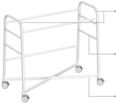
• **Latéraux** métalliques en forme de “U” inversé en tube cintré d’acier laminé à froid de Ø30 x 2 mm découpés et usinés au laser.
