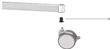
• À chaque extrémité, il y a des tubes ronds de Ø30 x 2 mm soudés où sont placés des **embouts** en polyamide noirs avec écrou métallique M8.
